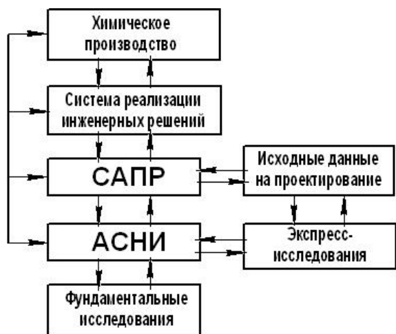
Рис. 3. АСНИ в структуре проектирования химических производств [3]
